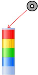
下図のように、積層信号灯の側面にセンサ部筐体を接触させてください
